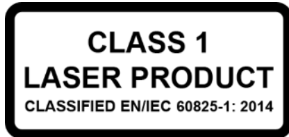
Рис. 6. Знак соответствия требованиям к лазерной безопасности датчика ToF
